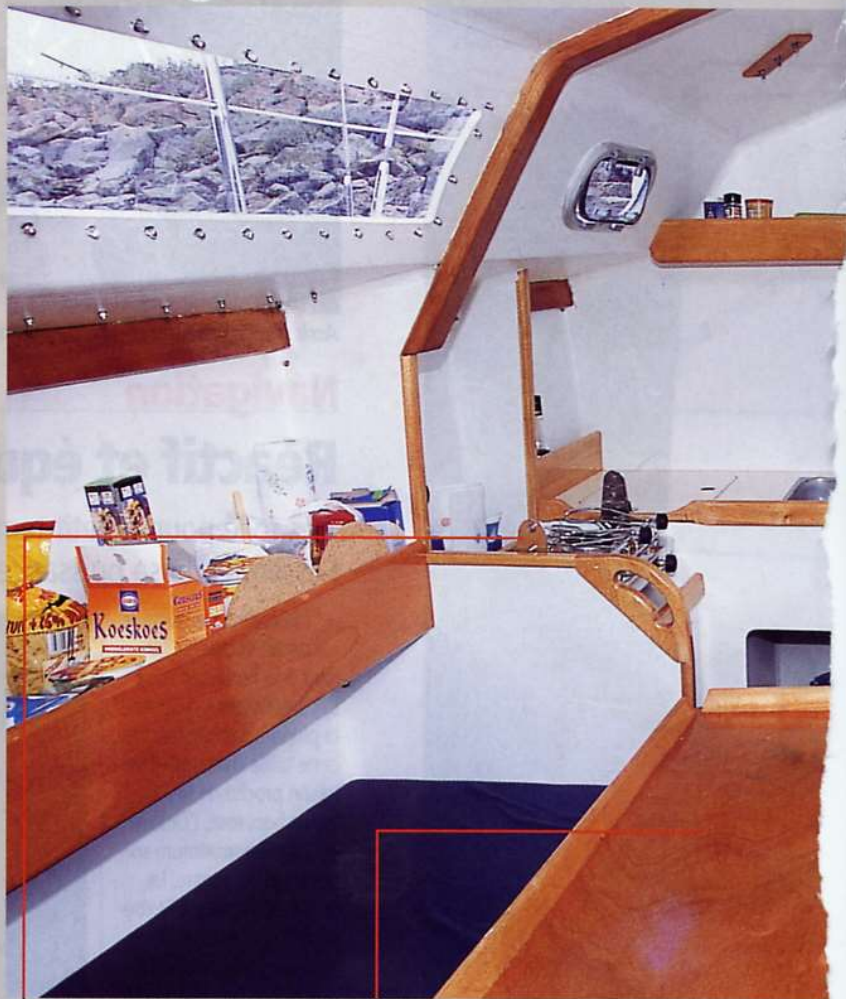
LA CUISINE est calée entre le puits de quille et la cloison avant. Elle est simple et pratique.
