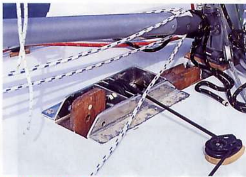
LE PALAN DE RELEVAGE de la quille est renvoyé sur un winch près de la descente.
